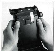
E. タイプ、88のフイルムバック87を使用するときは、ポラロイドバック G内のガイド切り込み(A)とフイルムバックの凸部(B)とを合わせて入れてください。
