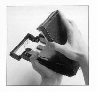
C. タイプ87、88フイルムを使用したときの操作は前項「フイルムパックの装塡」で説明したように、フイルムは裏蓋に押されて固定しています。したがって、裏蓋を開けるとフィルムがはずれないように、必ずフィルム面が下にくるような向き、まった開いてください。そのとき、フィルムパックが枠より浮き上がらない。よう指で押えて操作してください。
