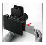
ポラロイドバックGの引蓋には〔<〕 マークがついています。これは〔<〕 マークが見える位置まで引蓋を抜けば、完全に抜きとらなくても撮影可能の位置を示しています。
