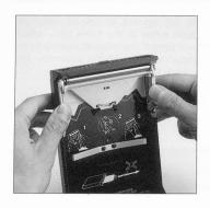
D. そして裏蓋内部のホコリをよく 吹きはらい、最後にローラーのアセ ンブリーを戻しておきます。 D. Use an air-blower and clean out the inside of the rear cover, before returning the roller assembly to its place.
