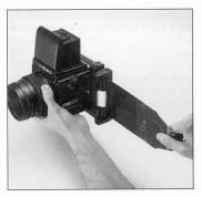
E. 黄タブをポラロイドバック Gから、まっすぐ静かに引き出します。 黄タブを引き出しきったときから現像が始まります。引き出す早さはどのくらいかと言えば「引き出す」とで普通の早さで言う時間ぐい出るいであれば引き出しかたが早いからであれば引き出しかっくりします。 E. Pull the yellow tab straight, moderately fast, in one smooth uninterruped action. Development starts when the yellow tab has been pulled completely out and, therefore, start timing development from that point. If the developed print is full of white specks, slow down a little as you are pulling too fast.
