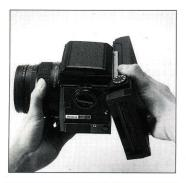
A. カメラからフイルムバックをはずし(GS-1カメラ使用説明書9頁、「フイルムバックの着脱」の項参照)カメラボデイ上部の取りつけ穴にポラロイドバックGの上部金具をさし込み、下部をカメラボデイに押しつけます。
