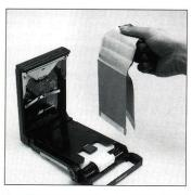
C. フイルムパックから、その一枚 を引き抜いたならばこれは捨てます。 裏蓋の開いている間にローラーが汚 れていないか点検してください。 C. Draw the yellow tab completely out of the pack film and discard it. While the Polaroid Film Back G is open, check the rollers and see if they are clean.
