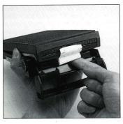
A. 遮光カバーを引き抜いてしまっても白タブが出ないときは、直射日光を避けて、日陰か室内で、裏蓋をわずかに開け、フイルムパックを動かさずに、白タブの端を外側に出します。
