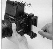
B. 白タブをカメラからまっすぐ、 完全に、一気に引き抜きます。 B. Pull the white tab straight out, until it is completely out of the Polaroid Film Back G, and then discard it.
