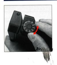
使用するポラロイドフイルムに合わせて、フイルム感度をポラロイドバックにセットしておきますと、露出計内蔵のファインダーと自動的に連動します。
